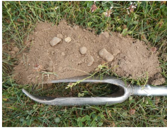
Résultats du sondage 4 : présence d'un substrat limono-caillouteux avec absence de traits rédoxiques.
