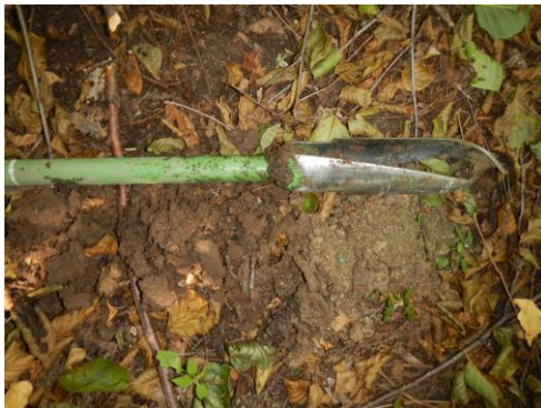
Résultats du sondage 6 : les marques rédoxiques (photo de droite) apparaissent avant 25 cm et se poursuivent en profondeur.
