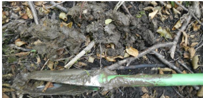
Résultats du sondage 5 : un sol tourbeux est mis en évidence sur l'ensemble du carottage.
