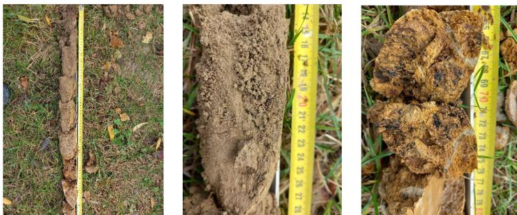
Profil typique de la catégorie Vb de la typologie GEPPA (hydromorphie de type rédoxique). À gauche : sondage n°4430 carottage complet ; au centre : segment 15-25 cm ; à droite : section à 70cm).
